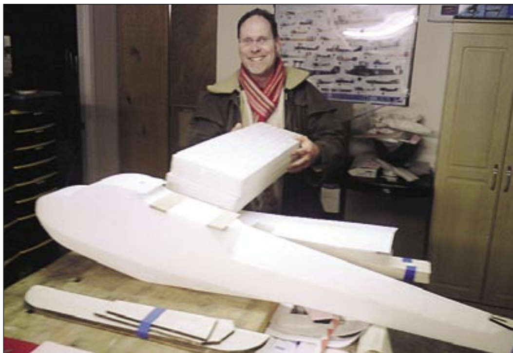
Jacques Des Becquets and his pre-production three-meter EPP Schweizer 2-33 glider. The kit features beautifully cut wing panels, the characteristic chunky fuselage and laser-cut balsa flying surfaces. / Jacques Des Becquets et son kit préproduction en mousse EPP du Schweizer 2-33. Le kit comporte des panneaux d'ailes très bien découpés, le fuselage un peu gras si caractéristique et un empennage de balsa très bien découpé au laser. PHOTO: Gudmund Thompson
