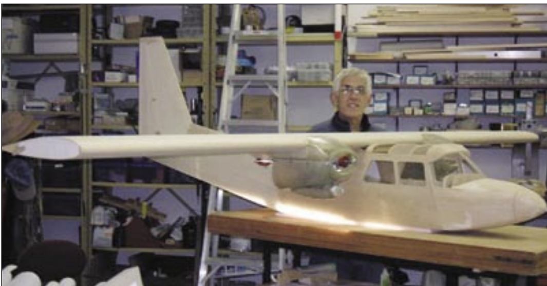
Phil Soden's quarter scale Islander twin, powered by a pair of 50 cc motors that should provide very good performance in the air. / Le bimoteur Islander à l'échelle un quart de Phil Soden, mû par deux moteurs de 50 cc, ce qui devrait lui conférer de bonnes performances en l'air.
