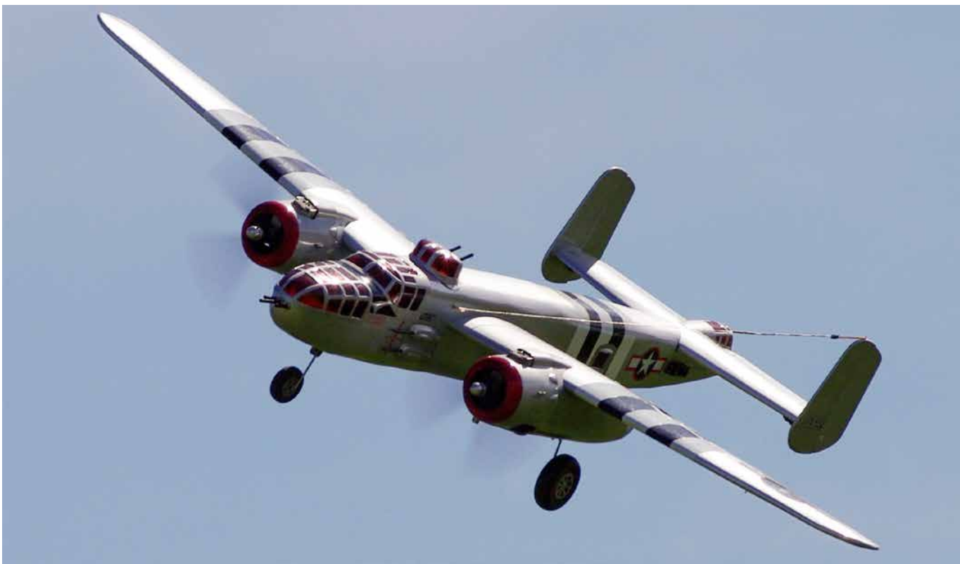
A gorgeous 72-inch span B-25 Mitchell on final approach. The model is powered by 2 OS 55s, uses 12 servos, and includes an operating bomb bay. The model can drop four marshmallows, each with four-foot streamers. / Un magnifique B-25 Mitchell en approche. Envergure de 72 pouces, motorisation par le biais de 2 O.S. 55, 12 servos installés et soute à bombes fonctionnelle. Cette maquette peut larguer quatre guimauves enrobées de banderoles de quatre pieds.
